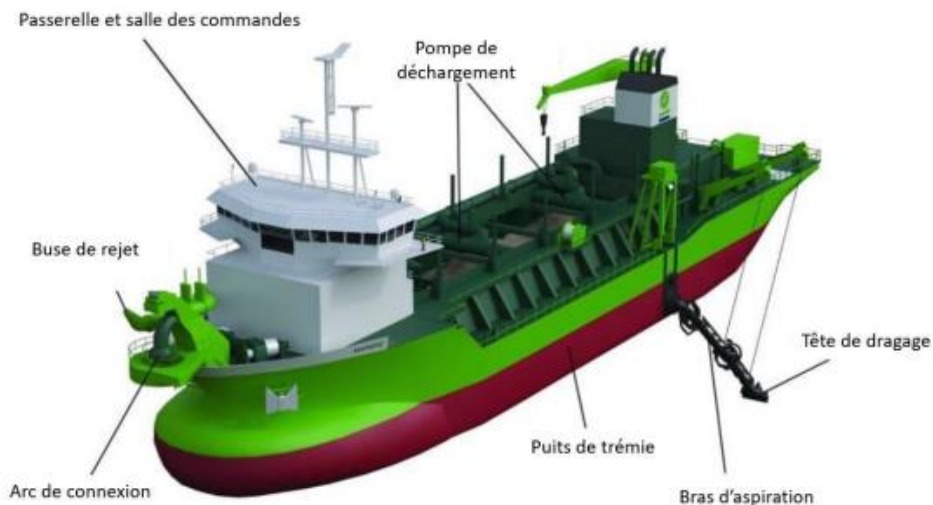
Exemple d'une drague aspiratrice (source : Technip Energies)
